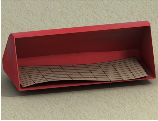
Figura 6.8: Para recoger material sobre una pala, necesitamos un Autómata Celular sobre ella.
