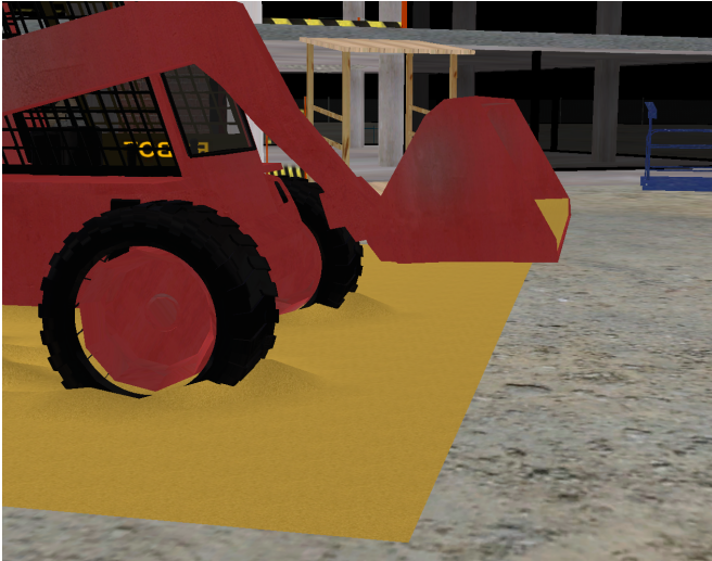
Figura 9.7: La interacción entre el suelo y la rueda puede simularse por medio de los conocidos modelos de Pacejka (Pacejka, 1996) sobre terreno pavimentado, y un modelo basado en la teoría de equilibrio límite sobre terreno blando.
