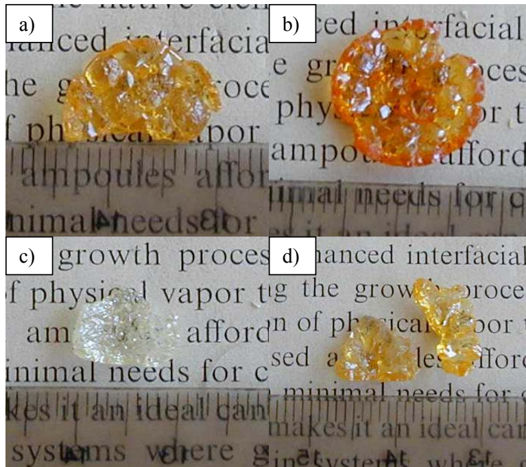
Figura 3.17. ZnO obtenido en experiencias utilizando ampollas: L \sim 6.5 cm y \phi_{int} \sim 1.5 cm, T_f \sim 1000^\circ\text{C} , \Delta T \sim 20^\circ\text{C} y a) P_i \sim 0.5 atm de Ar, b) P_i \sim 2.0 atm de Ar, c) P_i \sim 0.5 atm de \text{CO}_2 , d) P_i \sim 2.0 atm de \text{CO}_2 .
