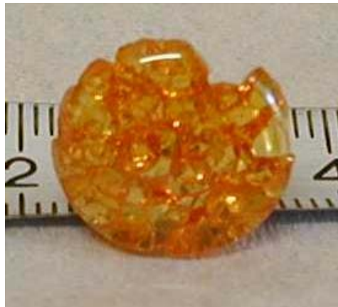
Figura 3.10. ZnO obtenido en una experiencia en configuración vertical en una ampolla con paredes grafitadas. Ampolla cilíndrica: L \sim 6.5 cm y \phi_{\text{int}} \sim 1.5 cm, m_{\text{ZnO fuente}} \sim 1.50 g, T_f \sim 1000^\circ\text{C} , \Delta T \sim 20 °C y P_i < 5 \times 10^{-7} atm.
