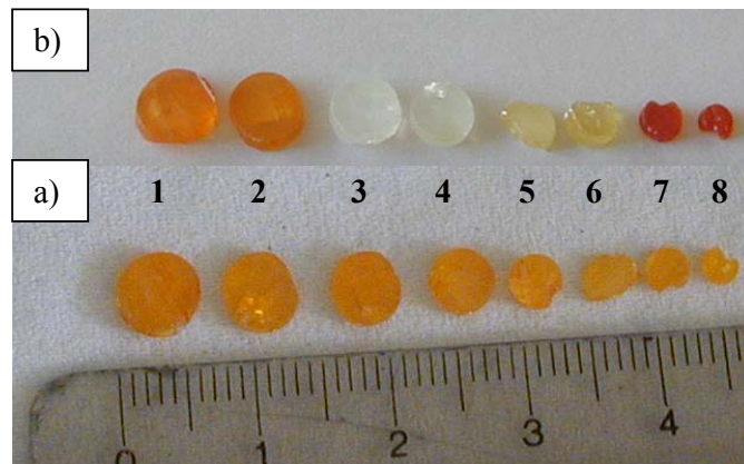
Figura 3.23. Lonchas de ZnO cortadas del cono obtenido en una experiencia con condiciones idénticas a la experiencia D. a) No sometidas a ningún tratamiento térmico. b) Después del tratamiento térmico: 1 y 2 sin tratamiento, 3 y 4 recocidas en O_2 ( P_{O_2} \sim 2 atm y T \sim 900^\circ C ), 5 y 6 recocidas en vacío ( P < 5 \times 10^{-7} atm y T \sim 900^\circ C ) y 7 y 8 recocidas en Zn ( P_{Zn} \sim 2 atm y T \sim 1000^\circ C ).
