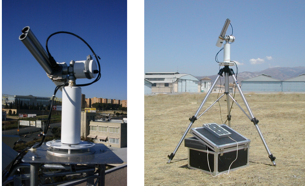
Figura 2.1: Fotografías tomadas del CE318-2 en Burjassot (Valencia) con la plataforma fija, y en Armilla (Granada) con la plataforma temporal.
