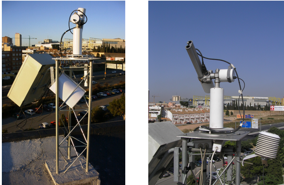
Figura 2.3: Vista Este de la instalación del equipo CE318-2 en la estación de Burjassot (izquierda) y detalle del fotómetro durante la medida (derecha).
