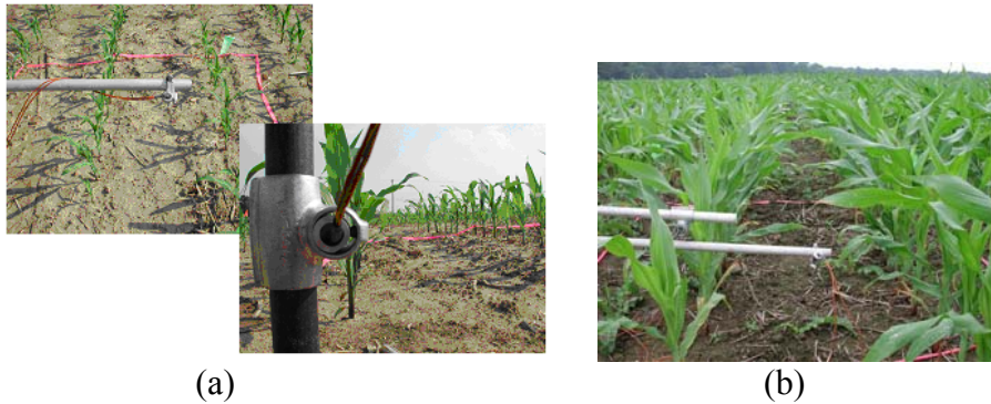
Figura 3.3.- Montaje experimental de dos radiómetros de infrarrojo Apogee IRTS-P3 para medir T_c y T_s . (a) 9/6/2004, (b) 23/6/2004.
