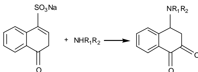
Figura 8. Esquema de reacción para el NQS con una amina secundaria.
