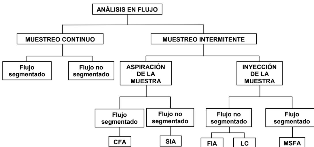
Fig. 1. Clasificación de los sistemas en flujo (IUPAC). CFA: flujo continuo multisegmentado. FIA: análisis por inyección en flujo. LC: cromatografía líquida. MSFA: análisis en flujo monosegmentado. SIA: análisis por inyección secuencial.
