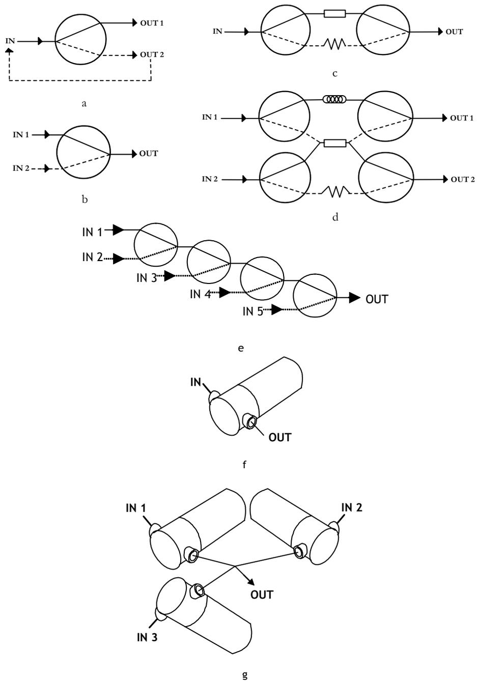
Fig. 18. Configuraciones mecánicas que permite la conmutación.
