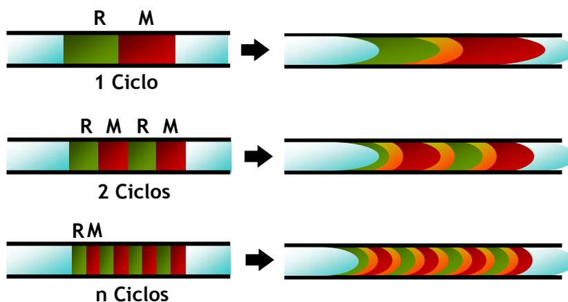
Fig. 19. Perfil de inserción que siguen muestras y reactivos en un modelo multiconmutado.
