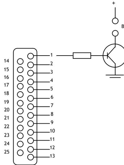
Fig. 33. Esquema electrónico para el accionamiento de las minibombas por el puerto paralelo de la impresora. B<sub>1</sub> - minibomba 1.
