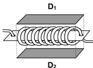
Fig. 40. Diseño de la celda de flujo empleada para las medidas por quimioluminiscencia.
