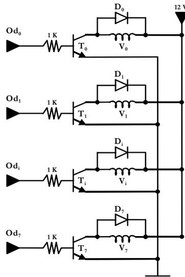
Fig. 32. Diagrama electrónico de la interfaz que conecta las válvulas solenoides.  $V_i$  = válvulas solenoides;  $T_i$  = transistores BC547;  $D_i$  = diodos 1N4002;  $O_{d_i}$  = líneas de salida digital de la tarjeta interfaz PCL-711S. Todas las resistencias se expresan en Ohm.
