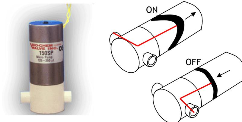
Fig. 17. Esquema del funcionamiento de una minibomba. En el dibujo puede apreciarse el movimiento que realiza el diafragma para propulsar la disolución a su paso por la minibomba.
