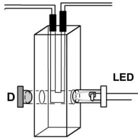
Fig. 41. Diseño del sistema empleado para las medidas fotométricas.
