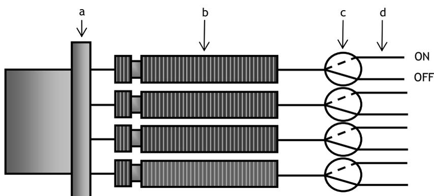
Fig. 9. Vista frontal de una bureta multijeringa. a: motor; b: jeringas; c: válvulas solenoides de tres vías; d: conectores y tubos de teflón o polivinilo. ON y OFF: válvula situada en la posición electrónica correspondiente al bit 1 y bit 0, respectivamente.
