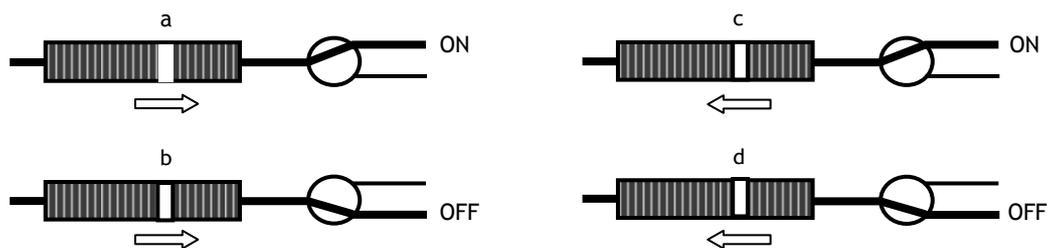
Fig. 10. Representación esquemática del mecanismo de distribución de una bureta multijeringa. a y b: movimiento del pistón en posición de propulsión de las disoluciones; c y d: movimiento del pistón hacia la posición de inicio. ON: conexión al camino de reacción; OFF: recirculación a los recipientes de disolución de partida o conexión al desecho.
