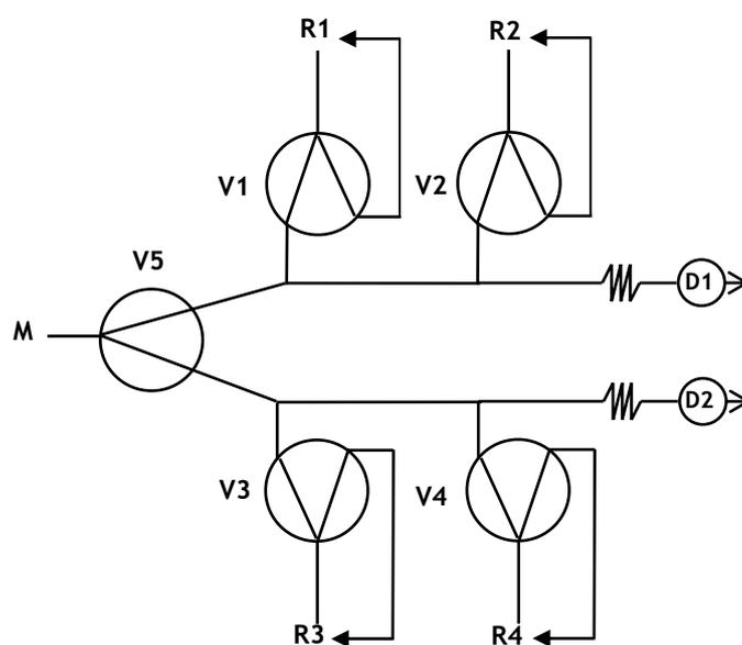
Fig. 23. Montaje para realizar multidetección en multiconmutación. V<sub>i</sub>: válvulas solenoides. M: muestra. R<sub>i</sub>: reactivos. D<sub>i</sub>: detectores.
