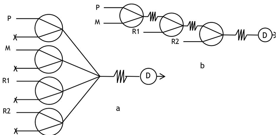
Fig. 24. Montaje en paralelo (a), montaje en serie (b).
