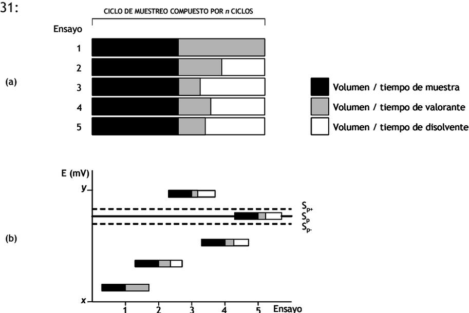
Fig. 31. Representación esquemática de una valoración por multiconmutación: (a) Perfil de muestreo, (b) Resultados hipotéticos.  $S_p$ : lectura promedio de la línea base;  $S_{p+} = S_p + q_s$ ;  $S_{p-} = S_p - q_s$ .
