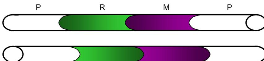
Fig. 6. Modelo de muestreo en un sistema SIA. P: portador; R: reactivo; M: muestra.
