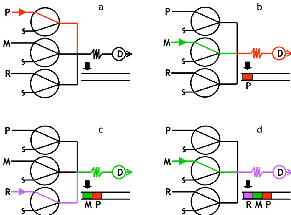
Fig. 21. Montaje experimental más simple en multiconmutación. (a): inserción del portador en el camino analítico. (b): inserción de una alícuota de muestra. (c): inserción de una alícuota de reactivo en tándem con la muestra. (d): inserción de una alícuota de muestra en tándem con el reactivo. P: portador. M: muestra. R: reactivo. D: detector.
