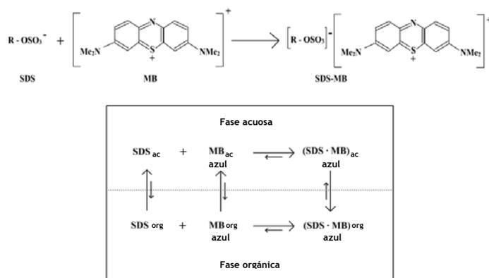
Fig. 36. Reacción entre el dodecilsulfato sódico y el azul de metileno en fase acuosa y orgánica.
