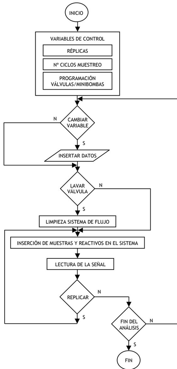
Fig. 34. Diagrama de flujo diseñado para multiconmutación por CV-AFS y HG-AFS.
