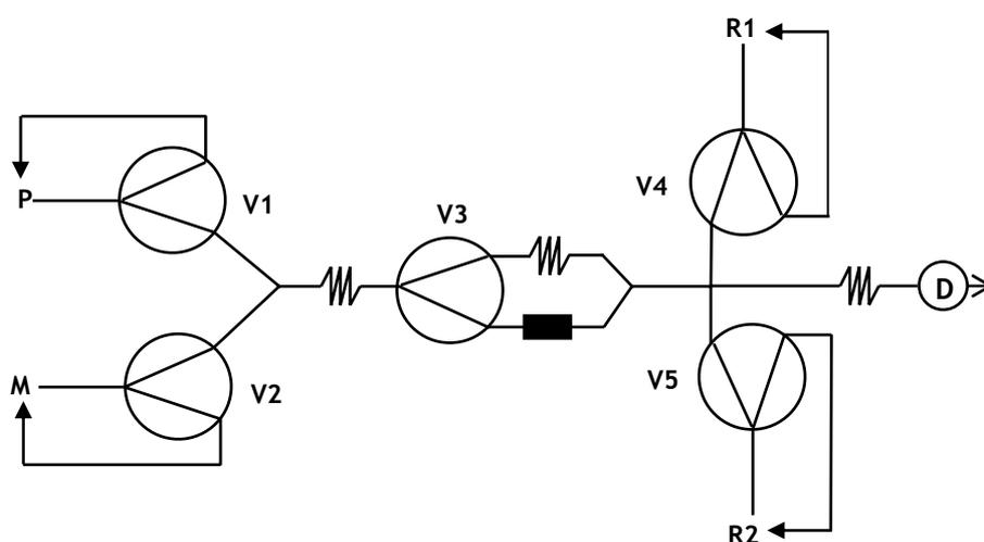
Fig. 22. Diagrama de flujo de un sistema multiconmutado mecanizado con recirculación y dos caminos de reacción.
