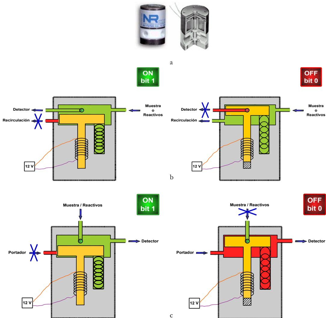
Figura 15. Funcionamiento de una válvula solenoide. a: aspecto externo e interno. b: Configuración IN, OUT<sub>1</sub> y OUT<sub>2</sub>. c: IN<sub>1</sub>, IN<sub>2</sub> y OUT.
