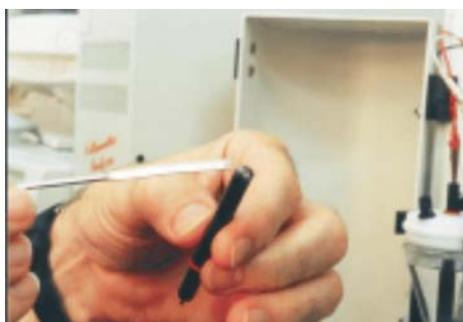
**Figura 17.** Imagen que muestra la modificación de un electrodo de trabajo de carbono vitrificado con la muestra a analizar.
