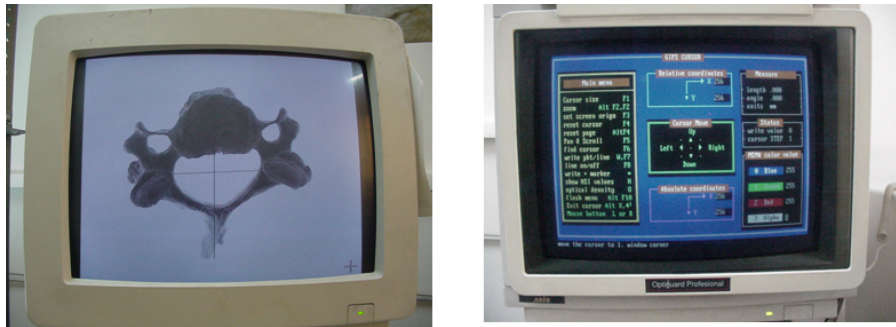
Figura 7.- Monitor izquierdo de alta resolución y monitor derecho con menú del programa análisis de imagen GIPS.
