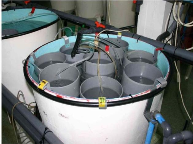
Figura 6.1. Dispositivo empleado en los experimentos de alimentación larvaria con nauplios de *Artemia* enriquecidos.
