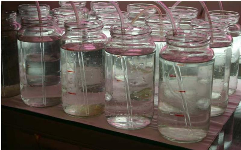
Figura 7.1. Dispositivo empleado en los experimentos de suministro directo de nutrientes a larvas de peces mediante baños de liposomas.
