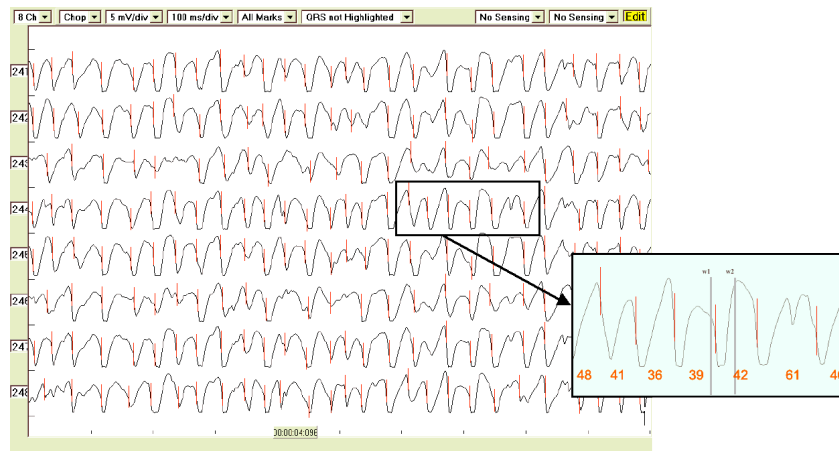
Figura 11: Marcado semiautomático de los instantes de activación en el programa PaceMap®. Se muestran 8 de los electrogramas de la zona modificada (1 segundo en pantalla). Detalle: La marca se sitúa en la máxima pendiente dentro de la ventana w1-w2. Se indican los intervalos VV.
