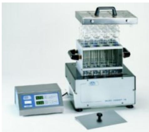
**Figura 4.3.** Digestor para el análisis del contenido de nitrógeno en muestras biológicas.
