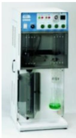
**Figura 4.4.** Destilador para el análisis del contenido de nitrógeno en muestras biológicas.
