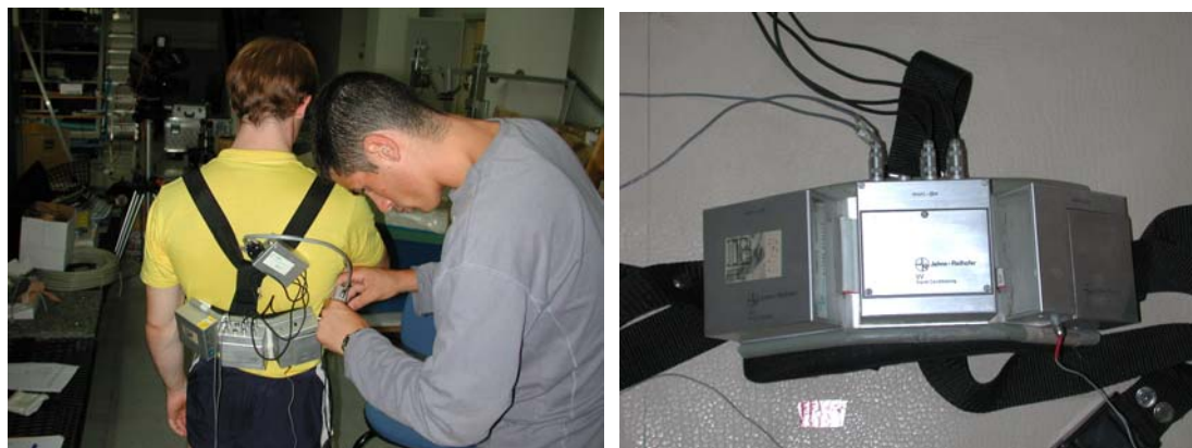
Foto 18.- Instrumentación mochila y cableado.
