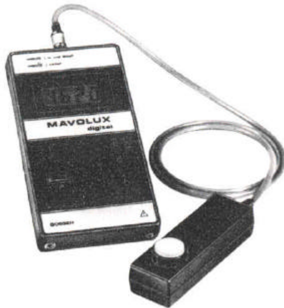
Figura 4.3. Luxómetro digital Mavolux utilizado para la medición de la iluminación.
