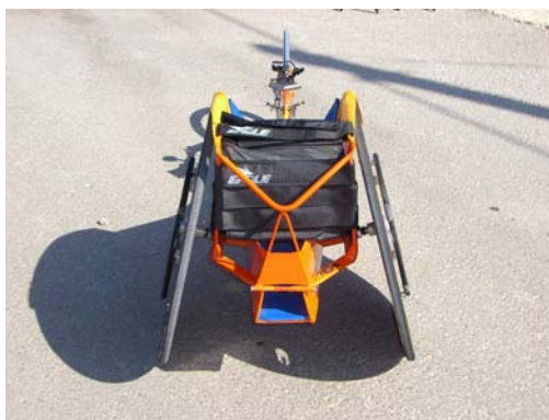
Figura 7: Vista posterior de una silla de ruedas de atletismo. Detalle del ángulo de camber.
