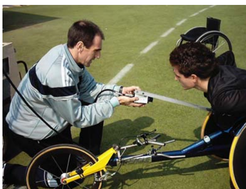
Figura 11: Montaje de la cámara de alta velocidad en la silla de ruedas.
