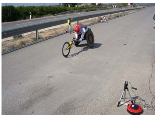
Figura 16: Medición de la velocidad durante un descenso sin carenado y con casco de contrarreloj.
