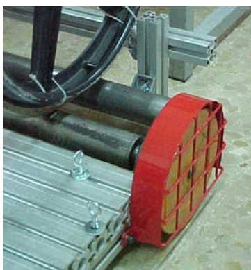
Figura 19: Detalle del volante que aporta la inercia en el ergómetro desarrollado.
