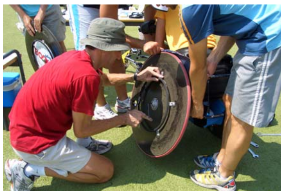
Figura 15: Cambio de aros durante el estudio de la optimización del aro de propulsión.
