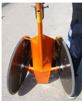
Figura 8: Vista inferior de una silla de ruedas de atletismo. Detalle del ángulo de "alineación".
