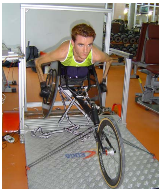
Figura 20: Vista general del ergómetro desarrollado (específico para atletas en silla de ruedas).
