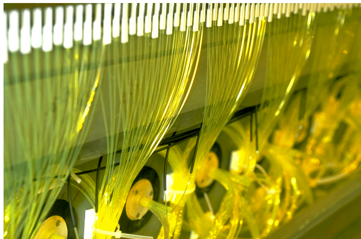
FIGURA 1.15 Agrupamiento de las fibras ubicadas en el interior de la viga.
