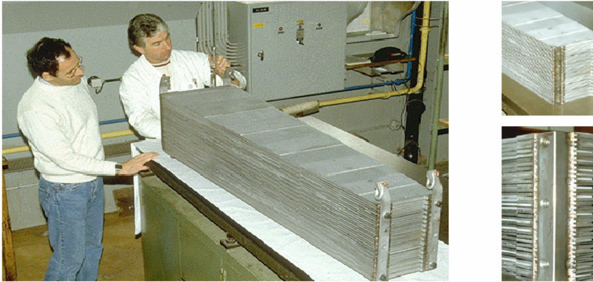
FIGURA 1.13 Montaje del periodo de un submódulo del calorímetro.
