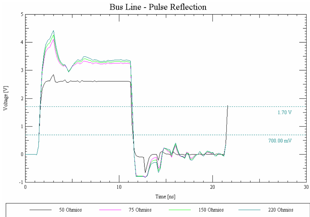
FIGURA 3.65 Reflexión con terminación ante un pulso para el bus de datos y control.
