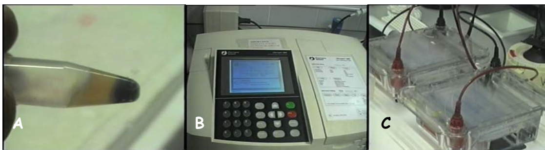
Fig. 35. - A: Eppendorf mostrando la porción soluble e insoluble del homogeneizado de una muestra de retina. B: Espectrofotómetro DYNATECH NR 7.000 sistema para la determinación colorimétrica de la concentración de proteínas. C: Realización de la electroforesis XCELL SURELOCK (invitrogel).
