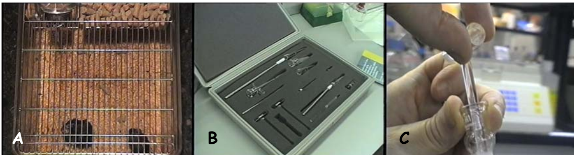
Fig. 34.- A: animales de experimentación previamente a su sacrificio. B: sistema homogeneizado de cristal SHEATON -USA. C: Proceso de homogenización de las muestras.
