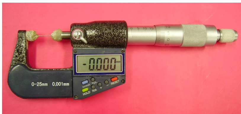
Fig.5.2: Micrómetro digital modificado usado para medir el espesor de la dentina de las muestras.
