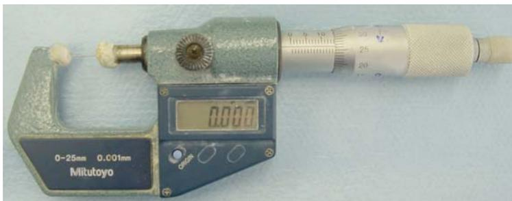
*Figura 2: Micrómetro Digital modificado para la medición de la altura de la dentina sobre la cámara pulpar.*
