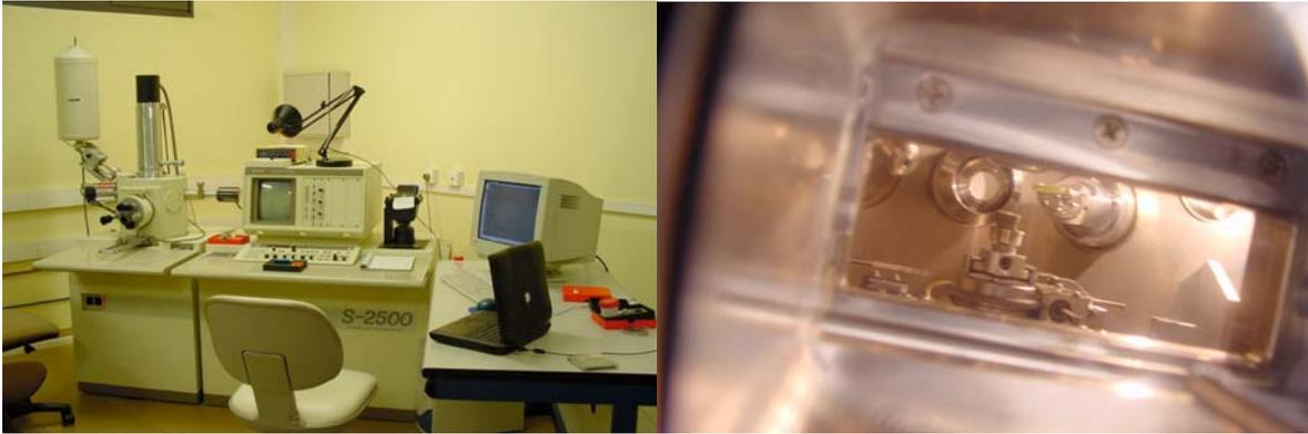
*Figura 11: Microscopio electrónico de barrido Hitachi 2500S y muestra en el interior de la cámara de vacío del SEM Hitachi 4500S Field Emission preparada para ser visualizada.*
