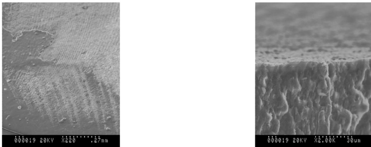
Imagen SEM 129, 130. En algunas zonas de la muestra (extensas pero no muy abundantes como se observa en la visión superficial a 220 aumentos), sin embargo es evidente la desaparición de la capa de Xeno III®-Ammident® totalmente y que los túbulos dentinarios están abiertos (muestra en visión lateral a 2000 x).
