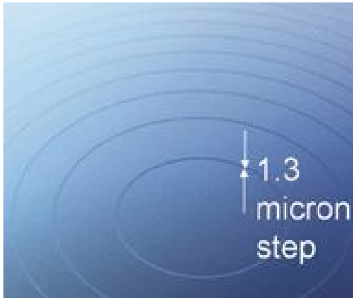
Figura 27. Microscopía electrónica de la ReSTOR TM mostrándose la superficie anterior apodizada. Los escalones se van haciendo menos altos con una primera discontinuidad de 1,3 \mu\text{m} y la última de 0,4 \mu\text{m} . (Tomado de DUANE'S Ophthalmology on CD ROM, 2006 Edition)
