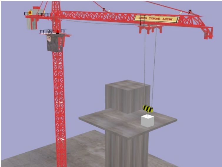
Figura 7.15: Experimento realizado para mostrar el efecto de la masa del cable durante la elevación de una carga. Cuando se inicia la maniobra de elevación, la carga no se eleva hasta que no se reduce la catenaria de los tramos horizontales del cable.
