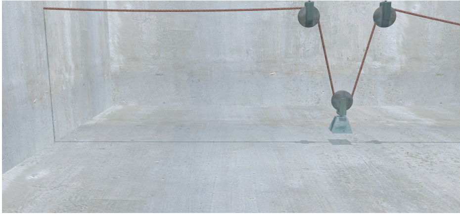
Figura 4.2: Para la integración de un modelo de polipasto en una simulación es necesario poder transmitir las fuerzas sobre los sólidos del sistema. Esto permite, por ejemplo, la elevación de una carga.
