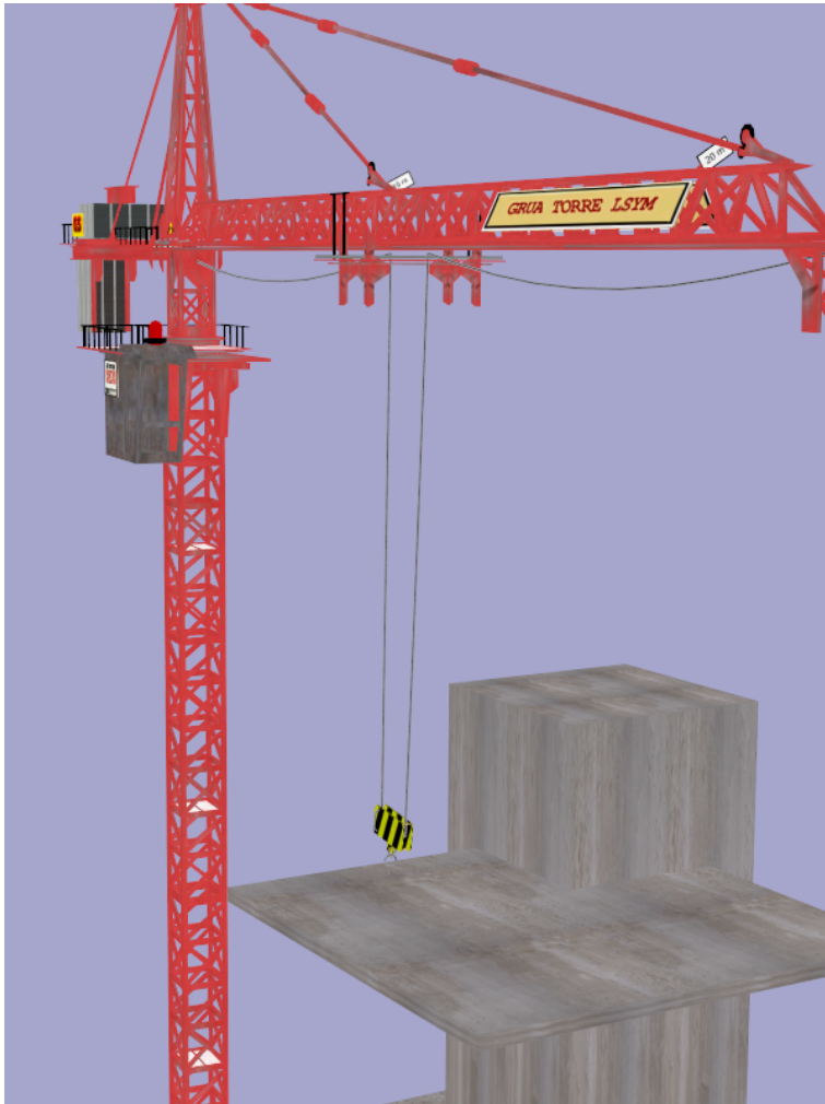
Figura 8.9: Se ha desarrollado un demostrador que simula una grúa torre de forma interactiva, utilizando los modelos de cable presentados en este trabajo.
