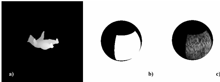
Figura 5.12 En a) mostramos el objeto “oso” rotado (45,90-30) a escala 0.6, en b) mostramos la función soporte v_0(\theta, \varphi) , en c) la PhFT correspondiente al objeto a)
