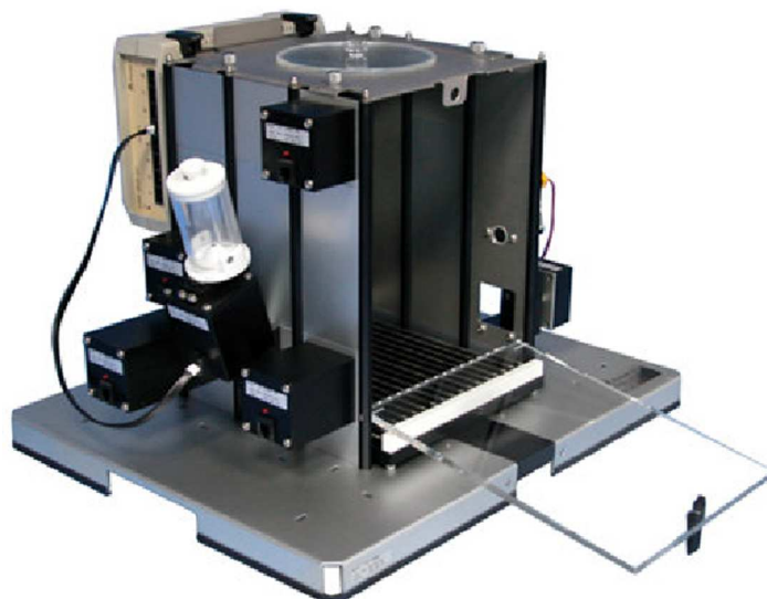
Figura 2. Caixa d'Skinner. En aquesta caixa l'animal pot ser exposat a estímuls de distintes naturaleses (luminosos, auditius) que poden ser associats a l'obtenció de menjar o a experimentar una descàrrega elèctrica a través de la reixeta de la base. També hi ha una palanca, la pressió de la qual pot ser reforçada positiva o negativament amb l'obtenció de menjar o amb una descàrrega elèctrica, respectivament. Mòdul per a comportament operant de Panlab, Harvard Apparatus.
