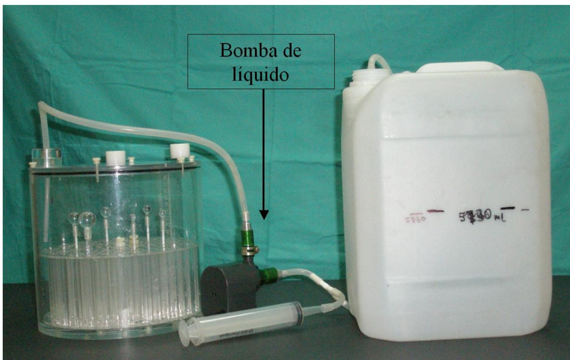
**Figura 10.- Sistema de llenado/vaciado del fantoma**
