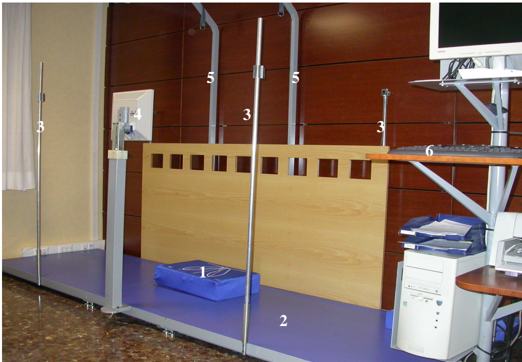
Figura 10. Sistema de posturografía NedSVE/IBV: 1) Gomaespuma situada sobre la plataforma dinamométrica. 2) Pasillo de marcha. 3) Células fotoeléctricas. 4) Monitor para el paciente. 5) Soporte para arneses. 6) Ordenador para el registro de los datos.
