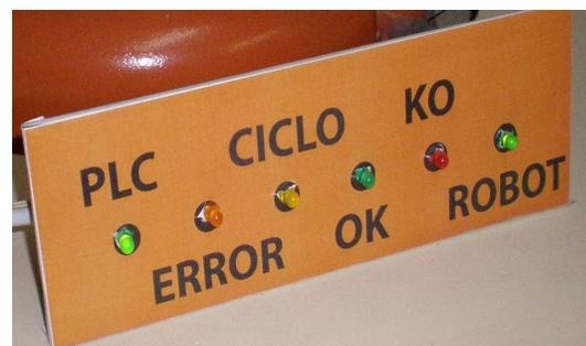
Fig.3. Panel estado en la base del robot.
