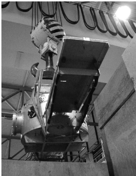
Colocación del RICH en la zona experimental H 8
