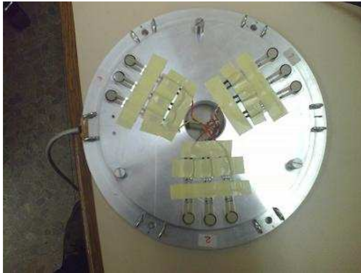
Imagen 5. Disposición de los sensores en la plataforma de fuerza
