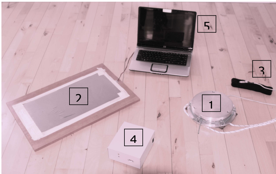
Imagen 3. Diagrama que representa las partes por las que está formado el sistema de adquisición de datos: 1. Plataforma de medida de fuerza; 2. Plataforma de contacto; 3. Cinta elástica con los Leds; 4. Sistema del Microcontrolador; 5. Pc.
