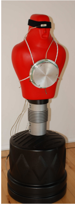
Imagen 4: Maniquí con la plataforma de medida de fuerzas, y cinta elástica con los leds.
