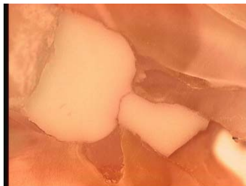
Fig. 127: Muestra 1. Grieta interna en el ionómero de vidrio autopolimerizable
