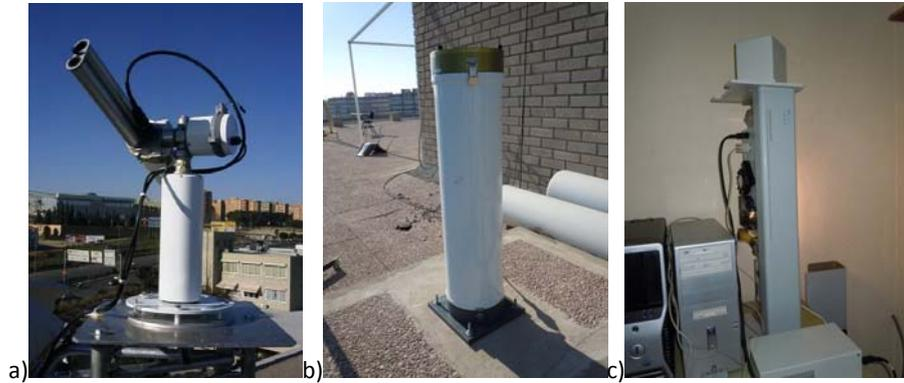
Figura 2.6 – Instrumentación del Grupo de Radiación Solar de la Universitat de València en la estación del Campus de Burjassot: a) fotómetro CIMEL CE318; b) micro-LIDAR CIMEL CAML CE370-2; c) nefelómetro de integración TSI 3563.
