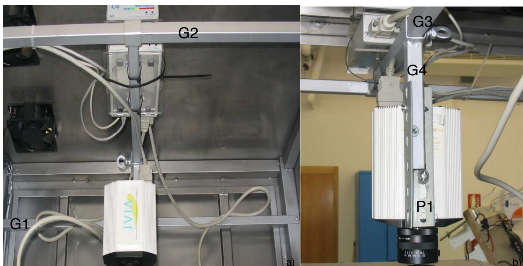
Figura 2.3: a) Guías G1 y G2 responsable del movimiento en la dirección longitudinal a la campana. b) Guías G3 y G4 responsables del movimiento de la cámara en la dirección transversal a la campana de inspección. La guía del perfil P1 permite variar la altura de la cámara sobre la escena.
