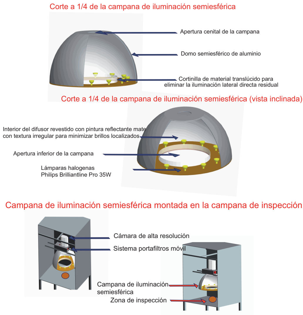
Figura 2.10: Diseño de la campana de iluminación esférica y su alojamiento en la campana de inspección.
