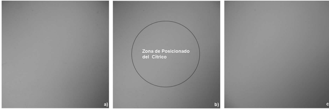
Figura 3.2: Imágenes monocromáticas del blanco de referencia (99%). a) Referencia blanca adquirida a 480 nm. b) Referencia blanca adquirida a 700 nm. En esta figura se muestra la zona aproximada donde se ubica el fruto en la adquisición. c) Referencia blanca adquirida a 980 nm.
