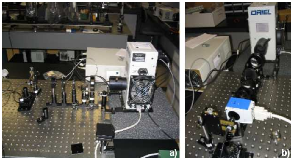
Figura 2.14: a) Banco óptico con los elementos necesarios para caracterizar los filtros. b) Detalle de la colocación del filtro en el banco óptico.
