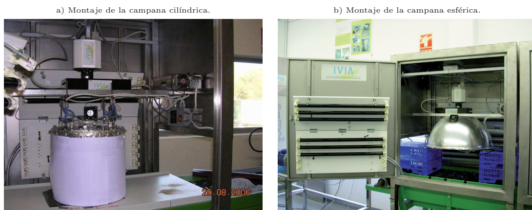
Figura 2.11: a) Campana de inspección montada al completo con todos los elementos ya instalados con a) la campana cilíndrica, b) la campana semiesférica.
