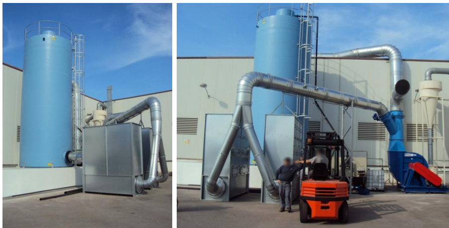
Figura 8.23. Fotografies de la instal·lació de la unitat industrial de biofiltre percolador en l'empresa Gamadecor Grupo-Porcelanosa.
