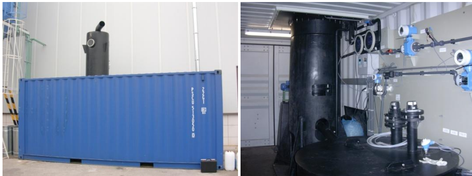
Figura 4.4. Fotografies de l'exterior i interior de la unitat pilot de biofiltre percolador (VOCUS®).
