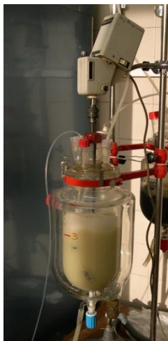
Figura 5.1. Reactor per al condicionament del fang activat als dissolvents a eliminar.
