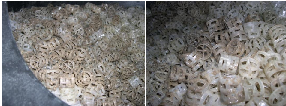
Figura 8.8. Fotografies de la part superior del llit de rebliment als 3 mesos d'operació.
