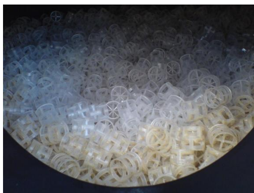
Figura 8.5. Fotografia de la part superior del llit de reblliment el dia de la inoculació.
