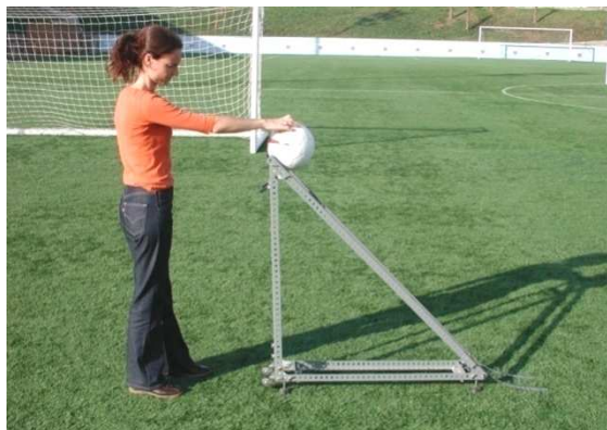
Figura 25. Rampa utilizada para el análisis de la rodadura en campos de fútbol.
