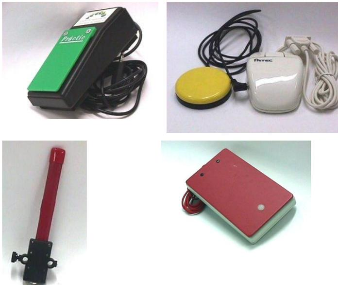
Figura 24.- Ejemplos de conmutadores utilizables para selección por barrido
