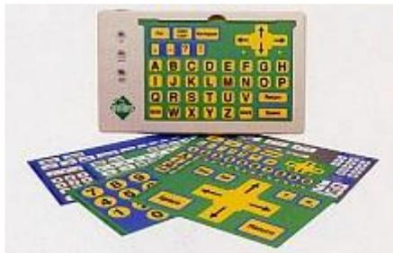
Figura 18.- Teclado plano con diferentes láminas (Intellikey de IntelliTools <http://www.Intellitools.com> )
