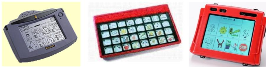
Figura 29.- Diferentes comunicadores electrónicos (Dynamo, AlphaTalker y SpringBoard)
