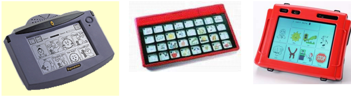
Figura 7 . Diferentes comunicadores electrónicos (Dynamo, AlphaTalker y SpringBoard)
