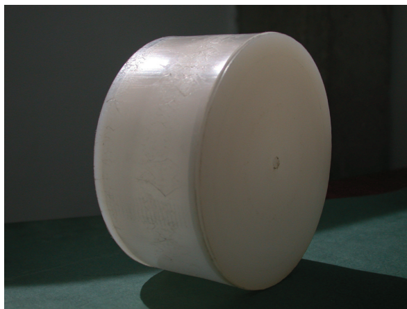
Figura 5.9: Maniquí de uniformidad, con un altura igual al FOV axial del anillo, 40 mm, y un diámetro exterior de 100 mm, que se corresponde con el 60 % del FOV transaxial del anillo.
