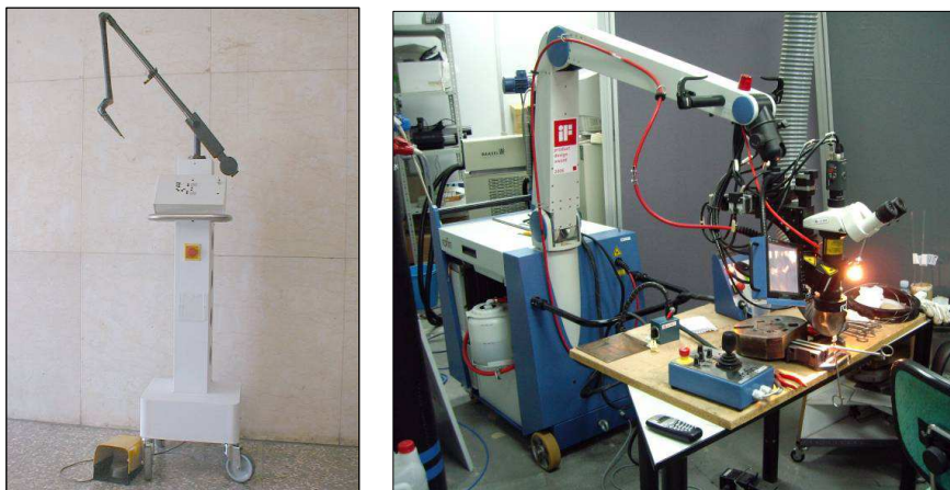
Figura 1.1. Dos ejemplos de sistemas láser. A la izquierda la fotografía de un prototipo de bisturí láser y, a la derecha una máquina láser para hacer revestimiento láser ( laser cladding ).
