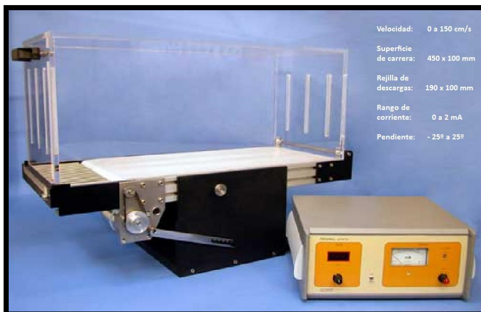
Figura 2.1. Tapiz rodante y unidad de control.
