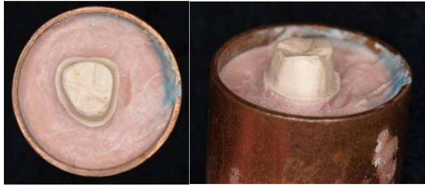
Figuras 11 y 12. Espécimen ubicado en un cilindro de cobre, que nos servirá de aditamento de anclaje para la mesa de reposición de muestras.
