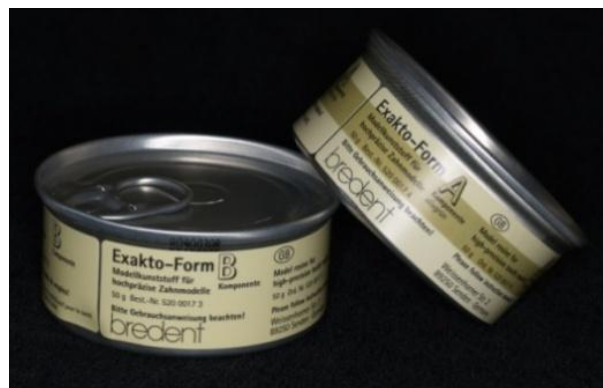
Figura 7. Resina epoxi (Exakto-Form.Bredent) utilizada para vaciar la impresión del modelo maestro.
