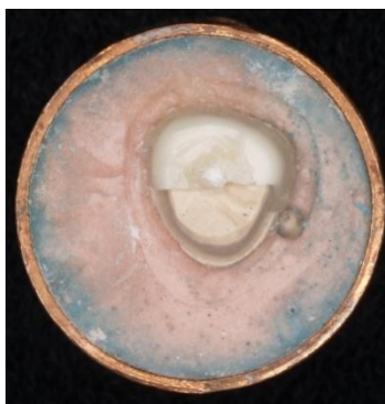
Figura 41. Especimen7 ZirCAD fracturado. Podemos observar el muñón de resina epoxi de la preparación que nos evidencia el fallo completo de la restauración.
