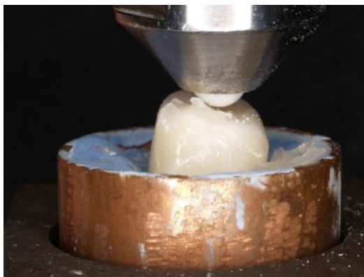
Figura 32. Fractura de la porcelana de recubrimiento tras someterla a carga.
