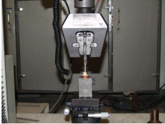
Figura 30. Abrazadera del aplicador de la carga y mesa de fijación de los especímenes.
