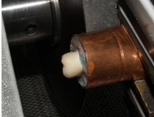
Figura 33. Seccionado del aro de cobre del espécimen para el análisis de M/E de la superficie externa.
