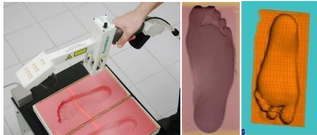
Figura 50.- Estudio de la pisada mediante el empleo de espumas fenólicas.
