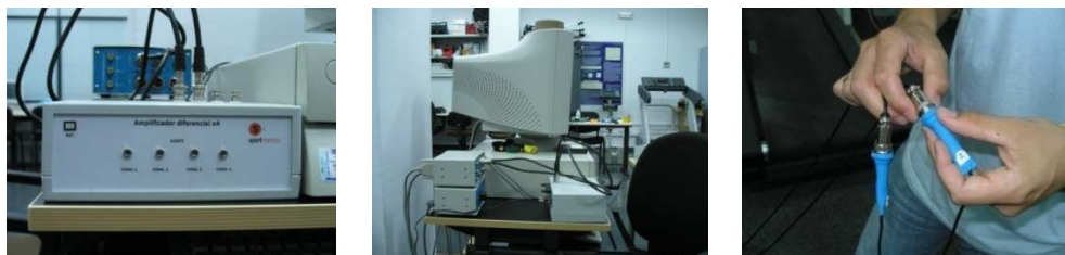
Figura 78.- De izquierda a derecha, amplificador de la señal de acelerometría, conexión de la señal de acelerometría a las entradas analógicas y conexión acelerómetros-prolongadores.
