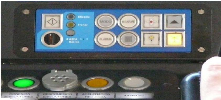
Imagen 9. Panel repetidor instalado en cabina
