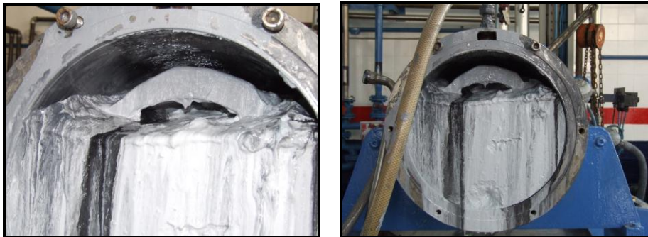
Fig. 2.2: Molino bloqueado por el aumento de la viscosidad de la pasta madre
