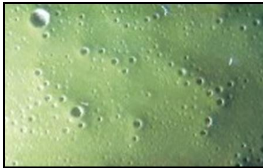
Fig. 1.33: Formación de pinholing-gassing. El voltaje fue excedido y se originaron excesivos gases (fotografía tomada a 15x)
