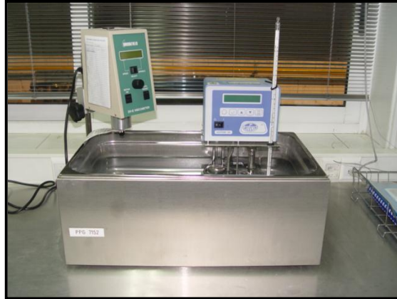
Fig. 5.32: Baño termostático Digiterm 100
