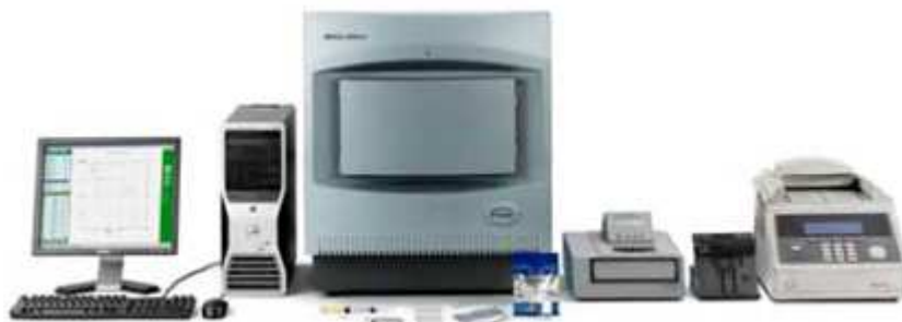
Figura 3.5. Instrumentos que componen la plataforma TaqMan Openarray Genotyping. De izquierda a derecha: Ordenador con software SNP OpenArray Genotyping, OpenArray NT Imager, dispensador para cargar las matrices, sellador de matrices y termociclador para matrices de OpenArray.
