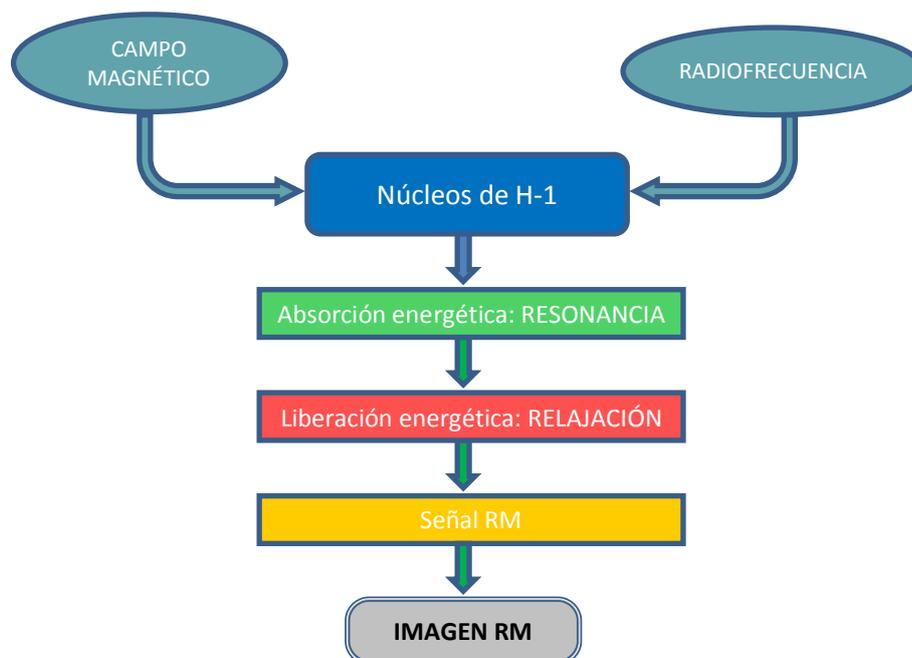
**Figura 12.** Esquema básico de la obtención de imágenes de RM.
