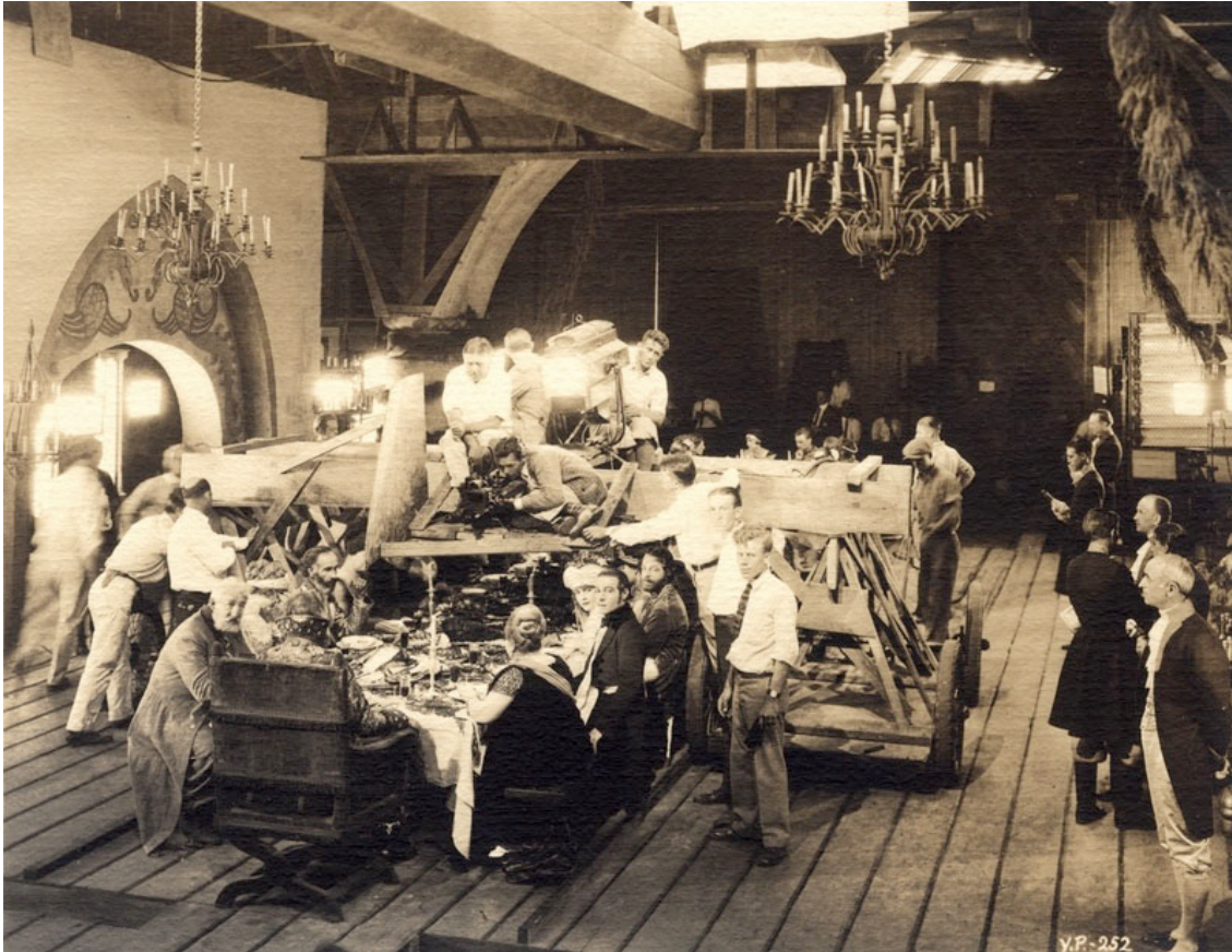
750. Fotografía en el set de The Eagle (1925) que muestra la plataforma con ruedas diseñada por Clarence Brown para la ejecución del travelling de retroceso por encima de la mesa.
