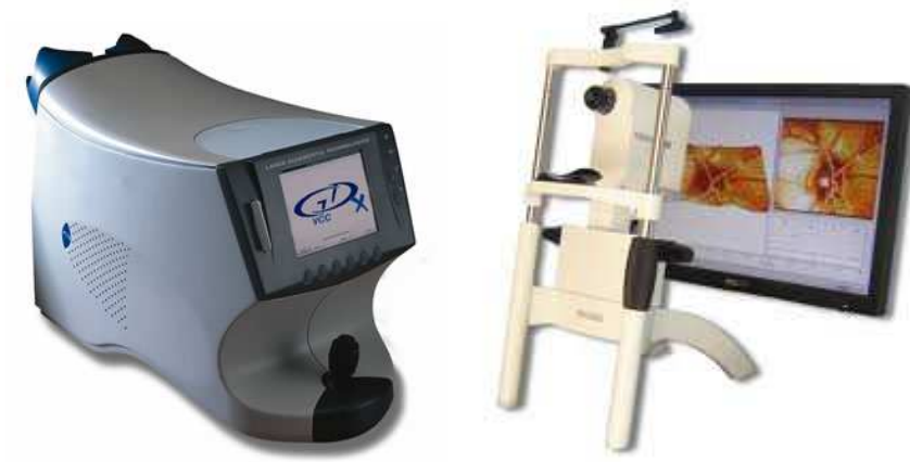
Imagen 11: A la izquierda aparato de polarimetría láser de barrido (GDx). A la derecha tomografía láser confocal (HRT-II)
