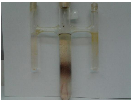
Esquema 4. Dispositivo especial para la cristalización del compuesto 1 .
