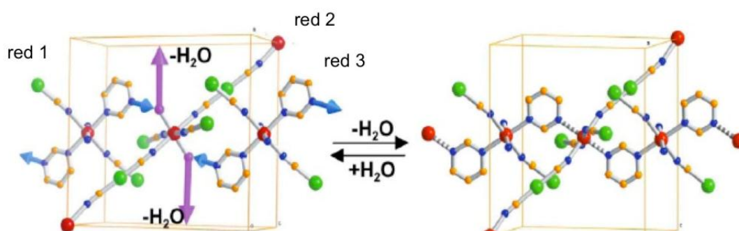
Figura 31. Celda unidad del compuesto \{\text{Fe}(\text{pmd})(\text{H}_2\text{O})[\text{M}(\text{CN})_2]_2\} \cdot \text{H}_2\text{O} mostrando fragmentos de las tres redes. Las flechas en los átomos de nitrógeno no coordinados (azul) y las de las moléculas de agua coordinadas (rosa) indican el movimiento dinámico que tiene lugar durante la reacción topoquímica en estado sólido.
