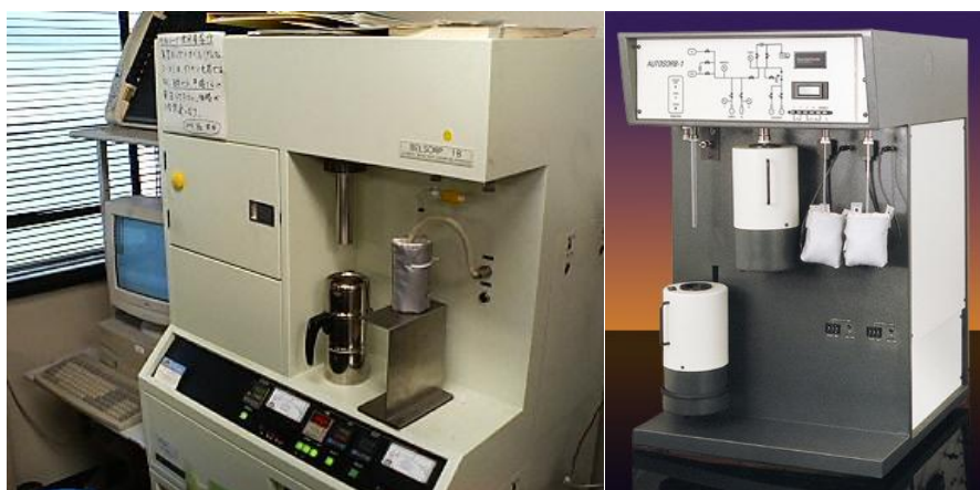
Figura 26. Equipos de medida de adsorción “Quantachrome-AUTOSORB-1” (izquierda) para las medidas de gases y “BELSORP-18” de la casa BEL Japan (derecha) para las medidas de agua, metanol y benceno.
