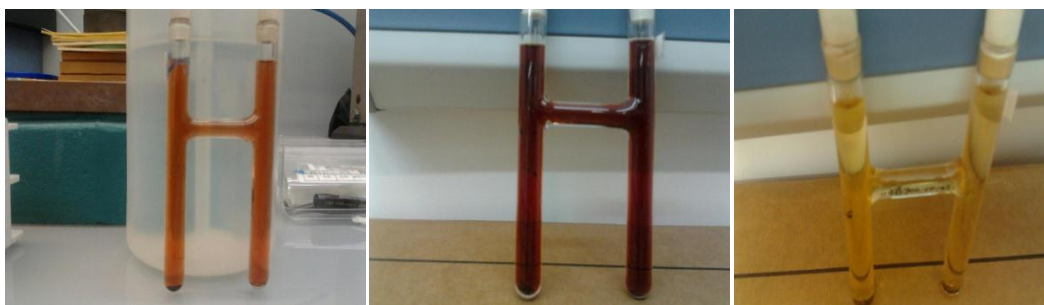
Esquema 1. Dispositivo para la cristalización de los compuestos 1a y 2 . A la izquierda, el compuesto 1a de coloración granate oscuro (negro); en medio, el compuesto 2 de coloración anaranjada; a la derecha, una ampliación sobre el tubo en H para el compuesto 1a .
