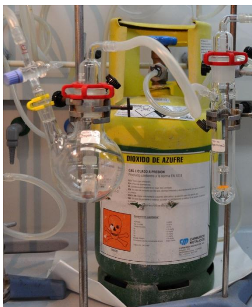
Figura 11. Coloración marrón oscura adoptada por una muestra de 3 (izqda.) tras la adsorción de \text{SO}_2 y amarillo-anaranjada (dcha.) al introducirla en un sistema de exposición con \text{SO}_2 (aún sin adsorber).
