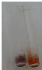
Figura 20. Cambio de color que acompaña a la transición de espín en 1-4 ; rojo oscuro (LS) estado de espín bajo y naranja (HS) estado de espín alto.
