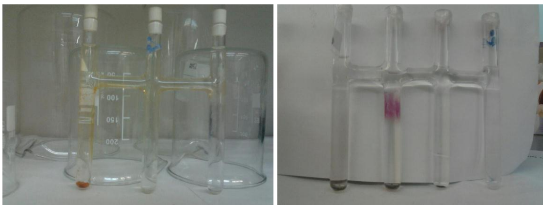
Esquema 1. Dispositivo especial para la cristalización de los polímeros 1 (izqda., dispositivo de tres tubos) y 3-6 (dcha., dispositivo de cuatro tubos).
