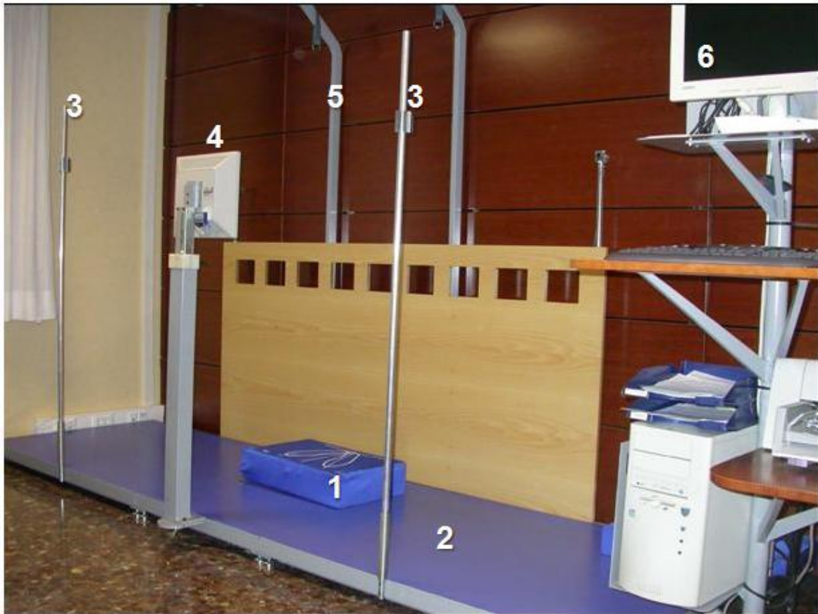
Figura 13. Sistema de posturografía NedSVE/IBV: 1) Gomaespuma situada sobre la plataforma dinamométrica. 2) Pasillo de marcha. 3) Células fotoeléctricas. 4) Monitor para el paciente. 5) Soporte para arneses. 6) Ordenador para el registro de los datos.
