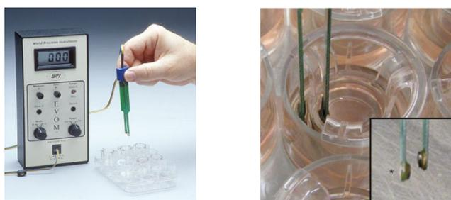
**Figura 15.** Voltímetro Millicell®-ERS y aplicación sobre un sistema Transwell® para la determinación de la RET.
