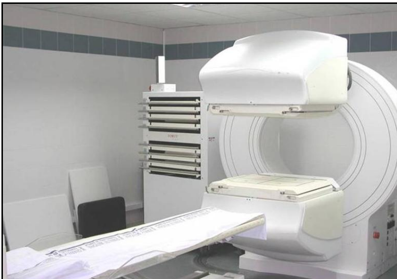
Figura 17: Gammacámara Philips®. ADAC Forte de 2 detectores, con colimador paralelo LEHR®, utilizada en el estudio.
