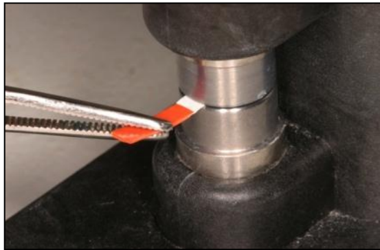
Figura IV.5: Colocación de la muestra de fluido crevicular en entre los sensores del Periotron®.
